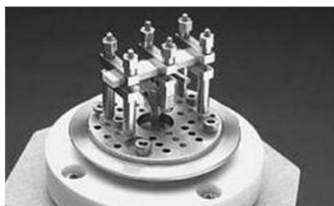
Obrázek 33: Schéma ukotvení vzorku a fotka samotného zařízení DMA - ukotvení Dual Cantilever. [22]
