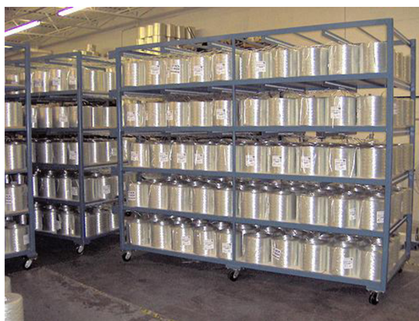
Obrázek 24: Zásobník rovingu Durapul Pultrusion Creel [19]
