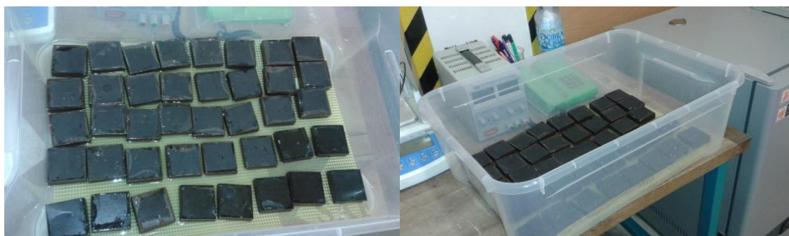
Obr. 6 Bukové a brezové vzorky vložené do nádoby s vodou
