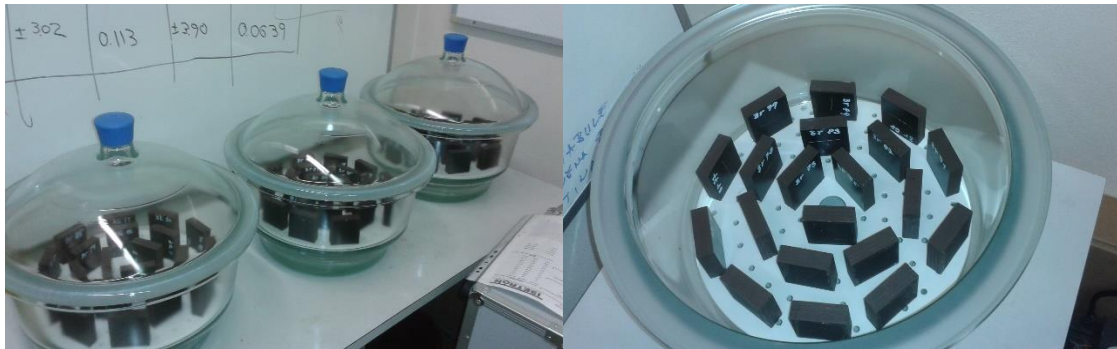
Obr. 5 Bukové a brezové vzorky v nasýtenej vodnej pare
