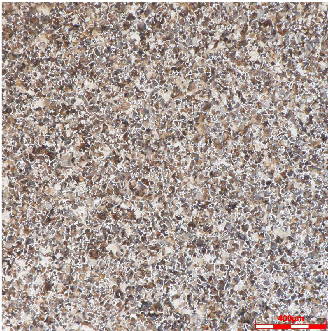
Obr. 4.4.1 Ocel 12060, zvětšení 150x, leptáno nitalem 2%
