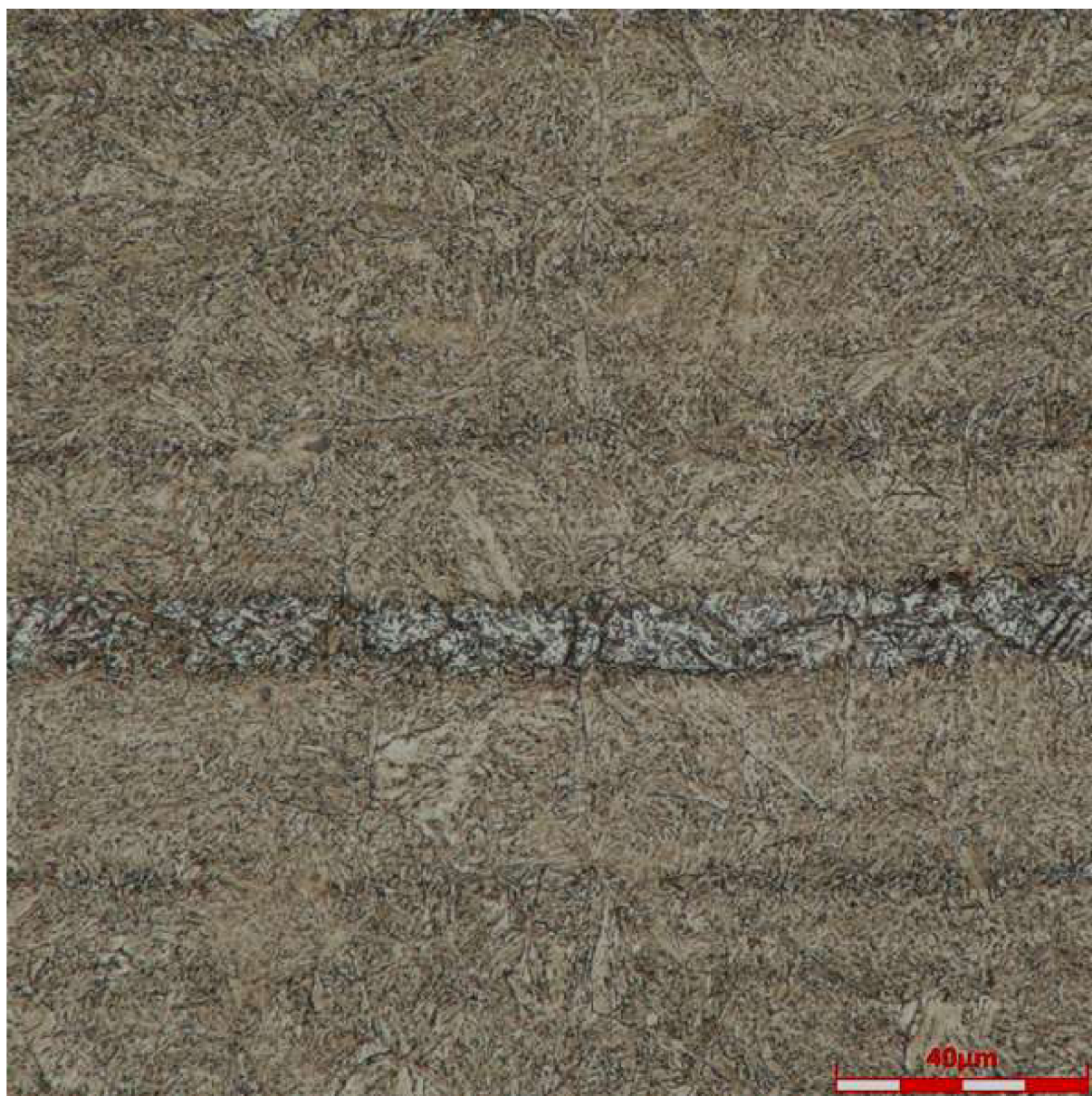
Obr. 4.2.3 Ocel 1.4748, zvětšení 1600x, leptadlo Villela-Bain
