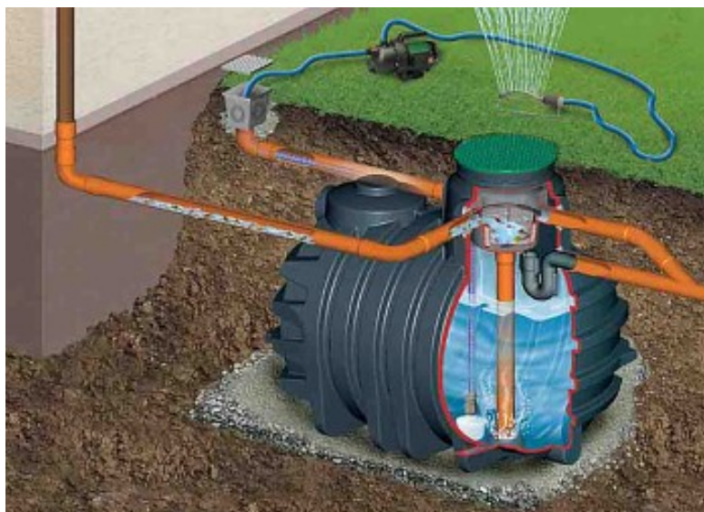
Obrázek 16: Podzemní plastová nádrž s připojeným čerpadlem (zdroj: Hlavínek a kol., 2007).
