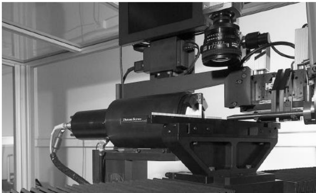
Obrázek 11. Přístroj Silviscan3, použitý k měření MFA pomocí rentgenové difrakce [7].
