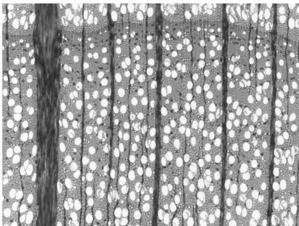
Obrázek 4. Roztroušená pórovitá struktura. Příčný řez bukového dřeva. (Zvětšení 40 x)
