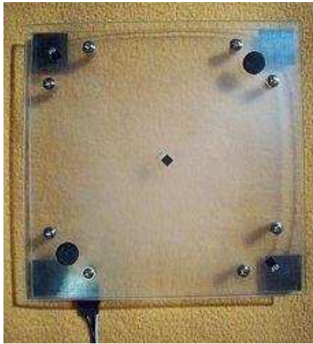
Obr. 11: Podložka pro měření teploty fotovoltaického článku
