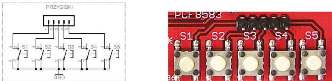
Obr. 7: Schéma zapojení tlačítek a obrázek tlačítek na desce
