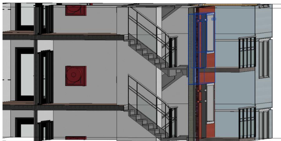
Obr. 32 Řez schodištěm s balkónem
