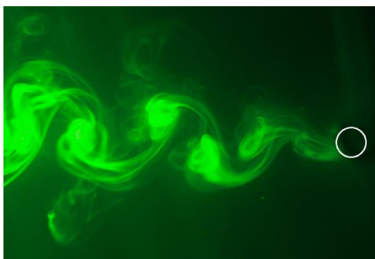
Obr. 7.5 Úplav při Re = 50 a zapnutém chlazení
