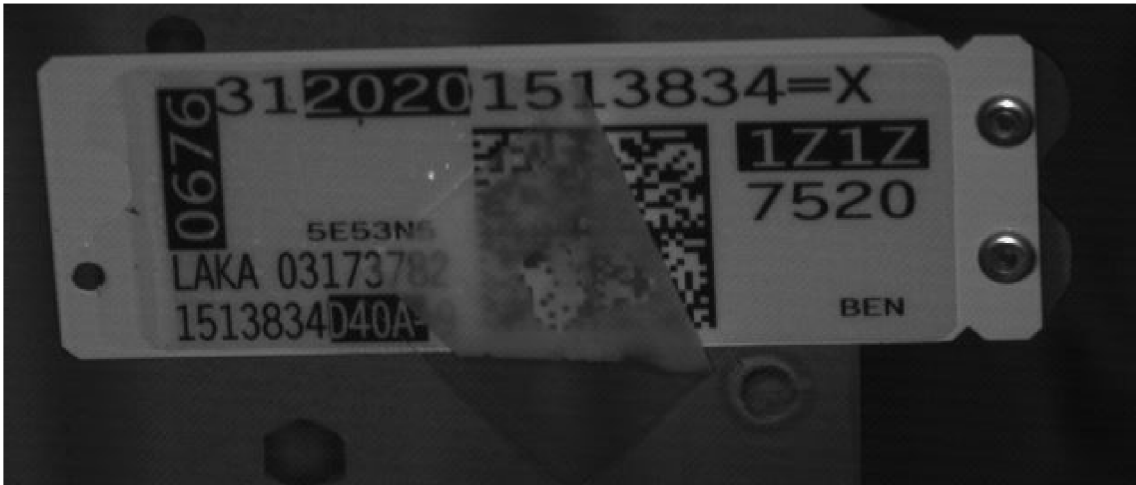
Obr. 3.3 Odlepená ochranná fólie TPS štítku
