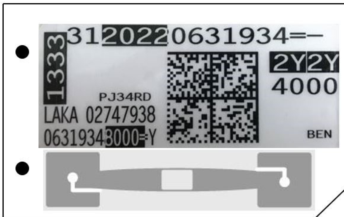
Obr. 3.9 Návrh RFID TPS
