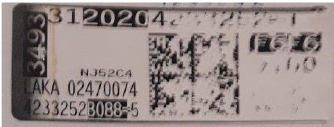
Obr. 3.4 Mechanické poškození dat TPS štítku
