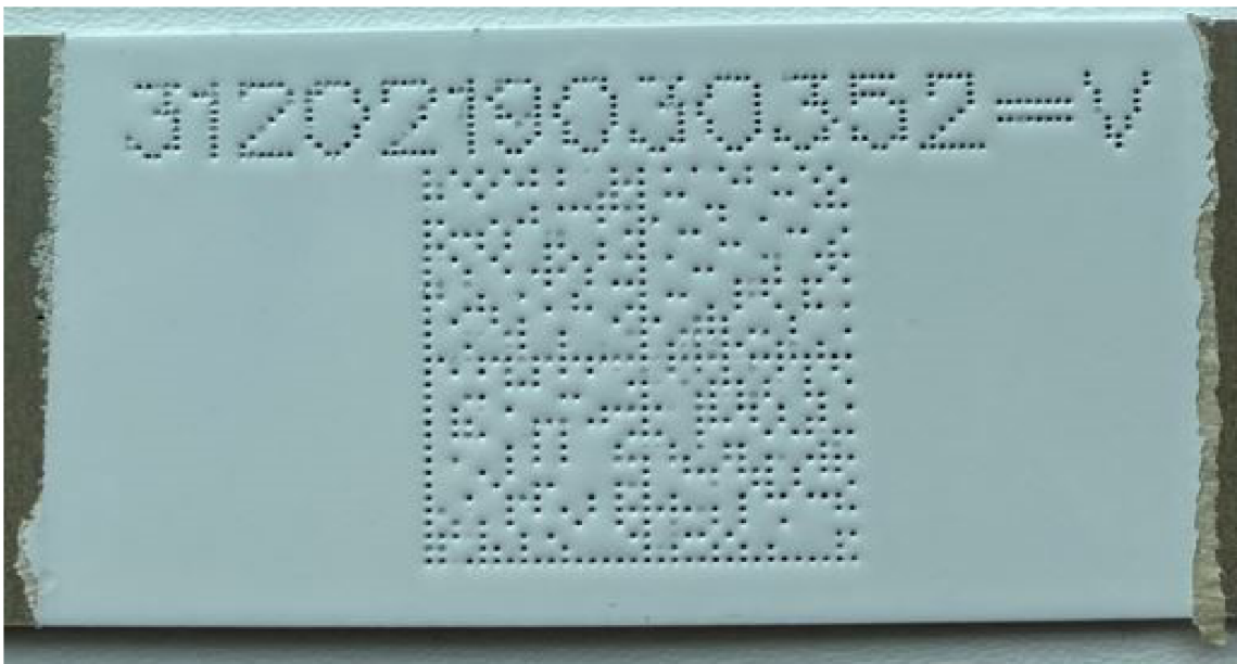
Obr. 4.2 Gravírovaný TPS po testu
