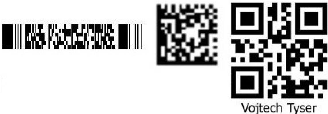
Obr. 1.7 Příklady dvoudimenzionálních kódů
