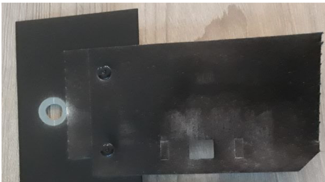
Obr. 4.3 RFID TPS po testu
