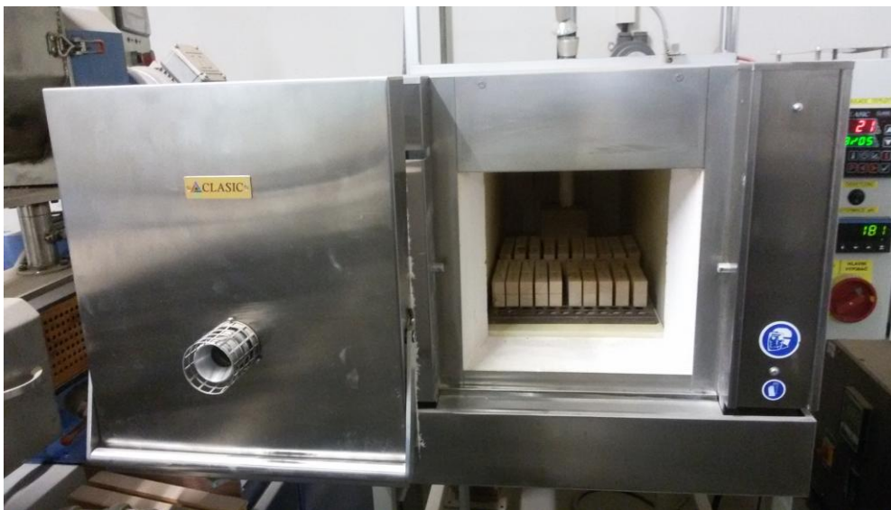
Obrázek 13 – Vzorky uložené v peci s elektrickým výhřevem
