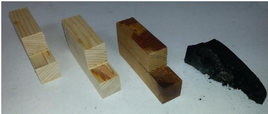
Obrázek 19 – Vzorky slepené epoxidovým lepidlem po vystavení teplotám 23°C, 110°C, 160°C a 220 °C
