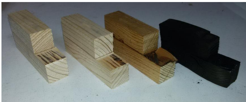
Obrázek 17 – Vzorky slepené RF lepidlem po vystavení teplotám 23°C, 110°C, 160°C a 220 °C
