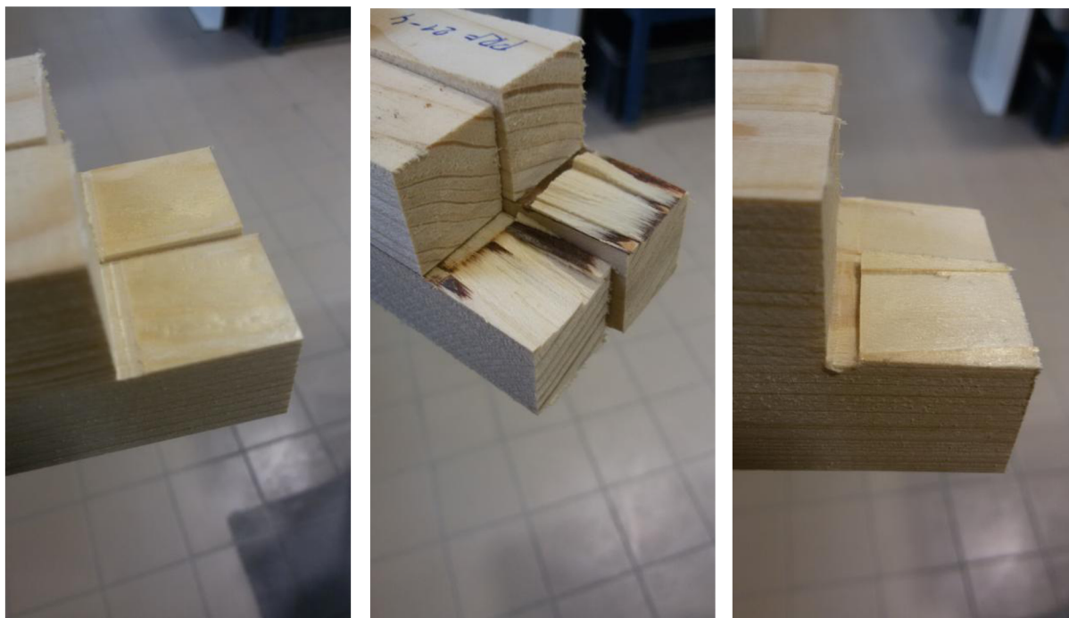
Obrázek 15 – Kohezní poškození dřeva (WF), zleva: 0 %, 80 %, 100 %
