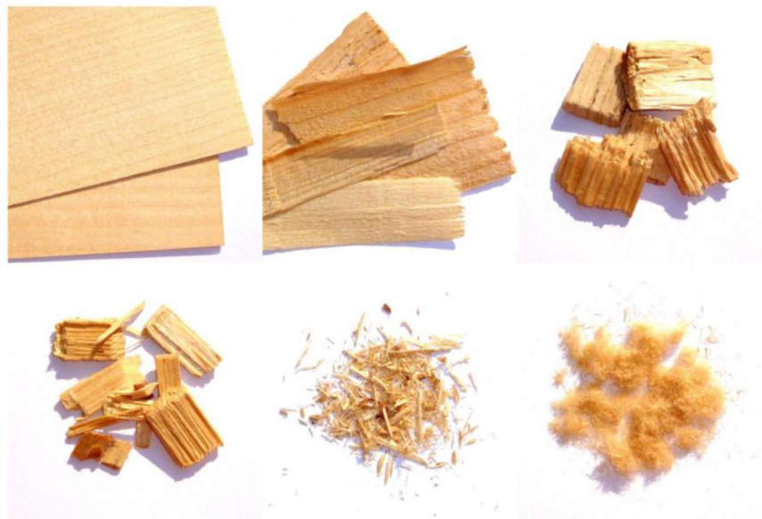
Obrázek 1 - Základní dřevní elementy, zleva shora: dýhy, velké ploché třísky pro výrobu OSB, bílá (papírenská) štěpka, štěpka pro výrobu třísek a vláken, třísky, vlákna [6].
