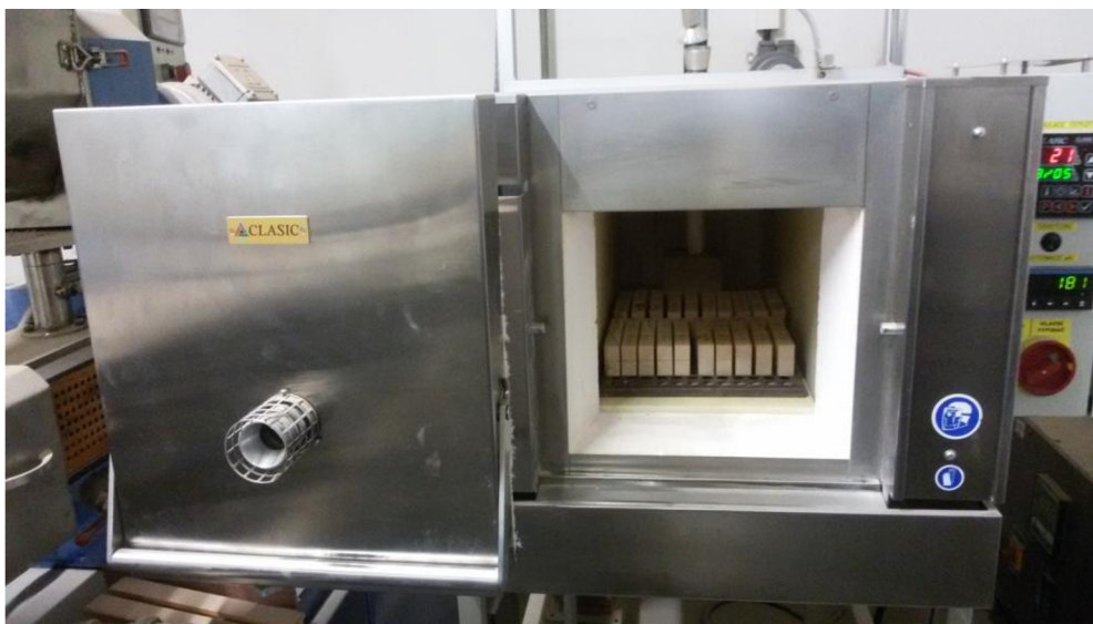
Obrázek 13 – Vzorky uložené v peci s elektrickým výhřevem
