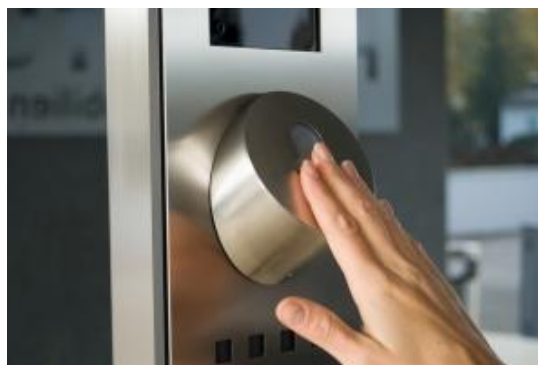
Obrázek č. 14 Biometrický systém kontroly vstupu 43
