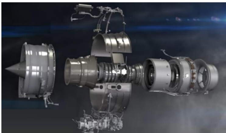
Obr. 14) TFE731 – dvouproudový motor společnosti Honeywell Aerospace Olomouc
