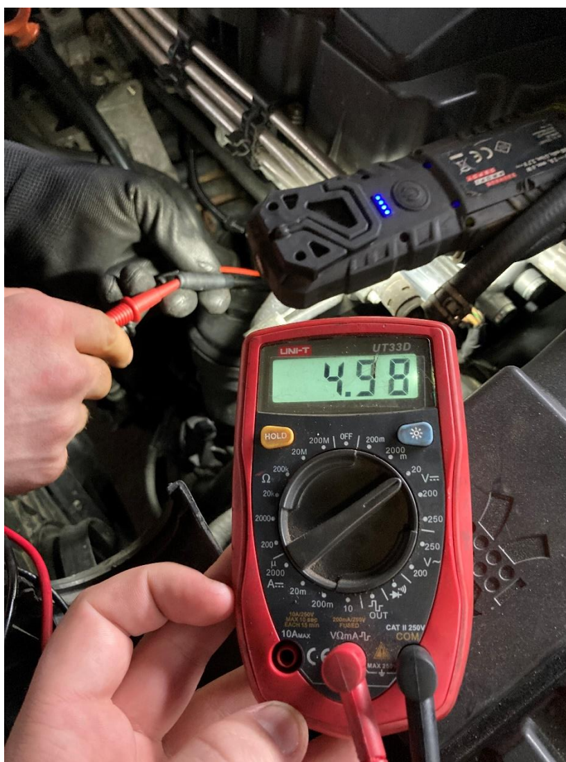
Obrázek 4.13: Kontrola snímače vačkové hřídele
