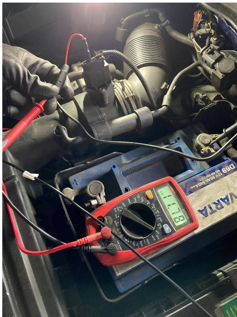
Obrázek 4.18: Kontrola snímače hmotnosti vzduchu
