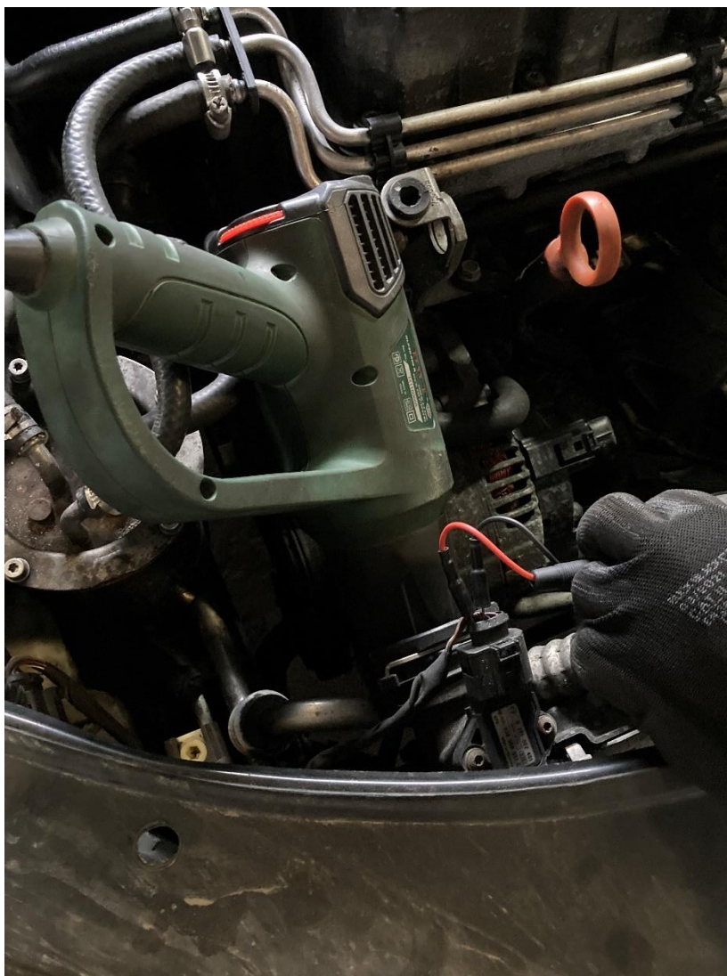
Obrázek 4.20: Kontrola snímače teploty nasávaného vzduchu
