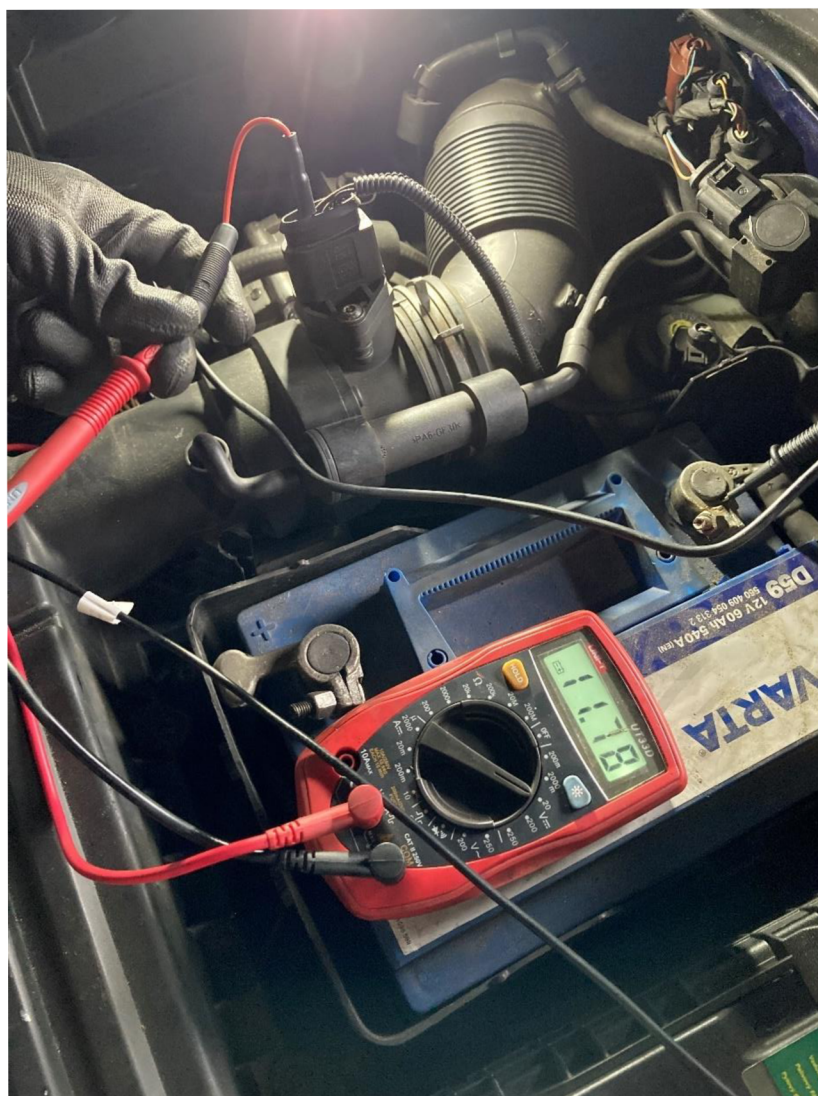
Obrázek 4.18: Kontrola snímače hmotnosti vzduchu
