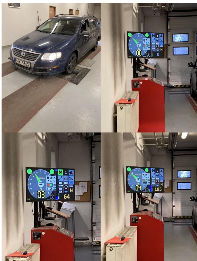
Obrázek 4.9: Válcová zkušebna brzd
