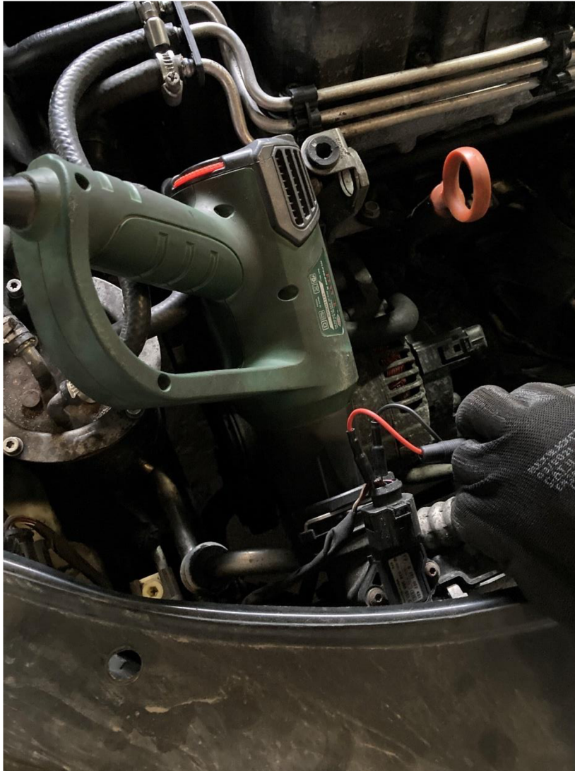
Obrázek 4.20: Kontrola snímače teploty nasávaného vzduchu
