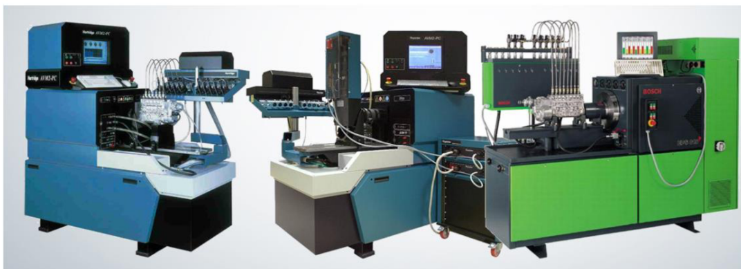
Obrázek 1.8: Zkušební stanice vstřikovačů
