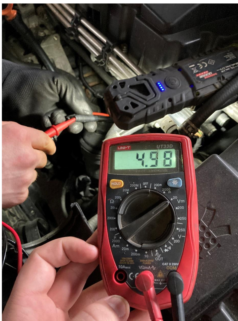
Obrázek 4.13: Kontrola snímače vačkové hřídele
