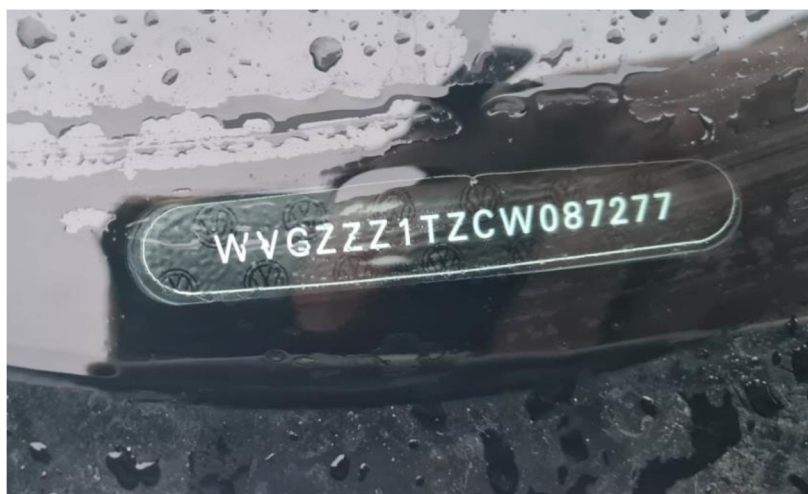
Obrázek 1.2: VIN kód pod čelním oknem vozu
