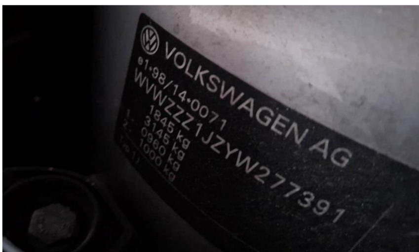
Obrázek 1.3: Výrobní štítek vozidla
