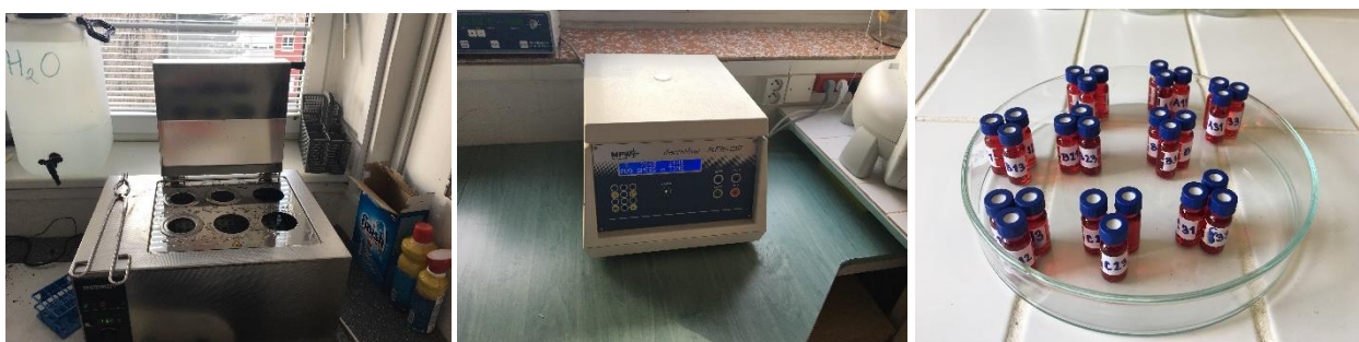
Obr. č. 8 – zleva: vodní lázeň, centrifuga, připravené vzorky pro HPLC stanovení (autor bakalářské práce)
