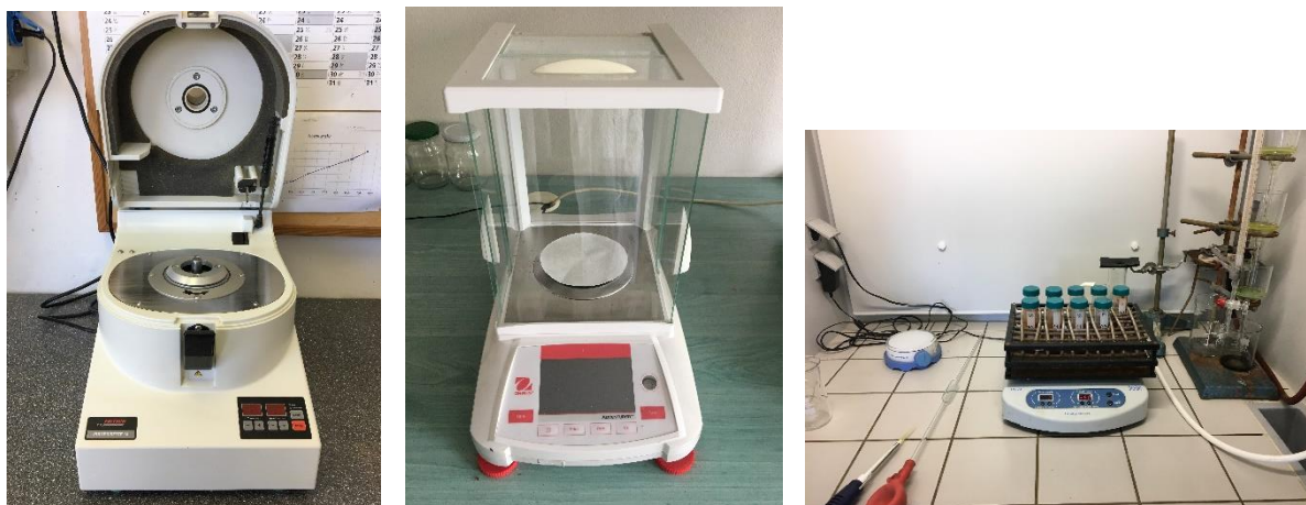
Obr. č. 7 – zleva: rychlomlýnek pulverisette 14, analytické váhy Ohaus, třepačka Biosan (autor bakalářské práce)
