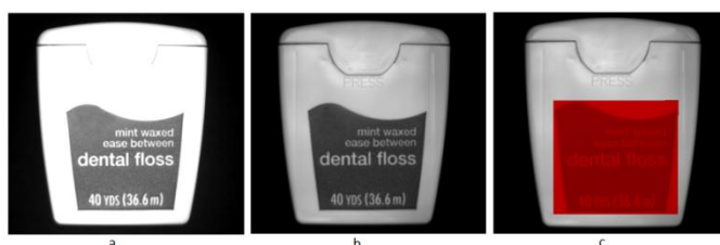
Obr. 17 – Rozdíly osvětlení ve vzorovém a kontrolovaném snímku – a) zlatý vzor, b) kontrolovaný snímek, c) jednolitý tmavý defekt, způsobený posuvem v intenzitě osvětlení. [16]
