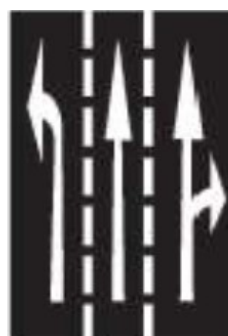
V9a Směrové šipky
