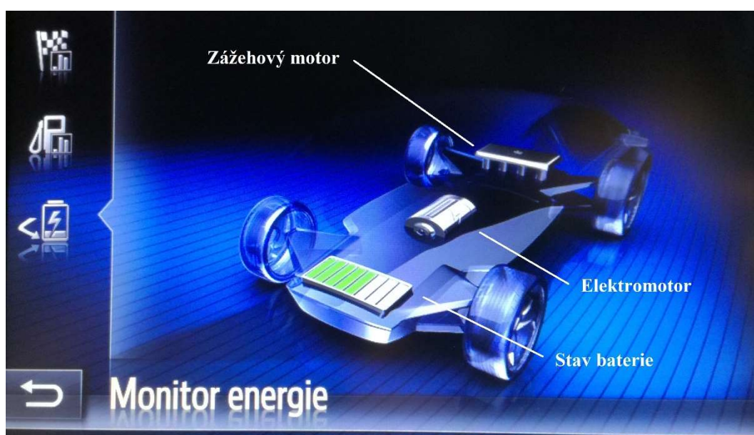
Obr. 18: Základní rozdělení pohonů - stav baterie, elektromotor, zážehový motor [54]
