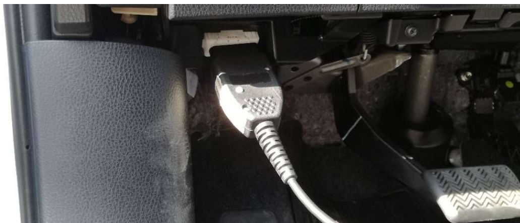
Obr. 24: Umístění OBD zásuvky ve voze Toyota RAV4 [54]
