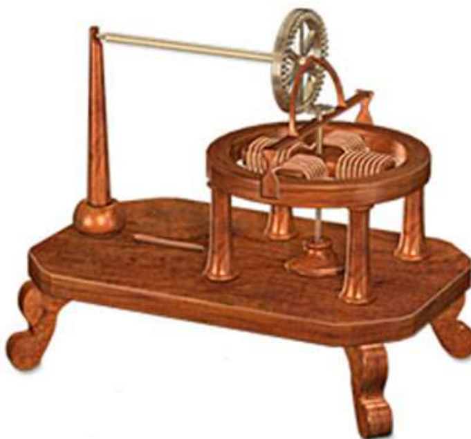
Obr. 2: Stejnosměrný elektromotor - vynález T. Davenporta [7]
