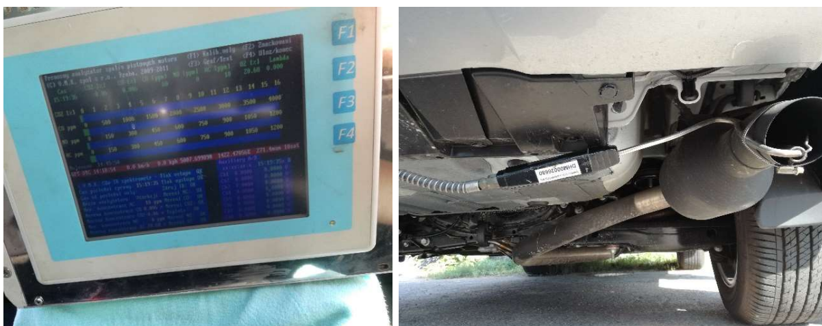
Obr. 22: Emisní analyzátor VMK (vlevo), upevnění snímačů emisních plynů do výfukového potrubí (vpravo) [54]
