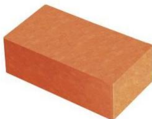
Obr. 4 Cihla běžného tvaru, jednou pálená [4]
