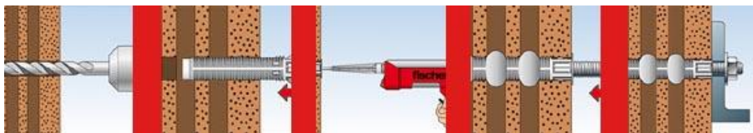
Obr. 35 Aplikace malty do děrovaných (dutých) cihel [41]
