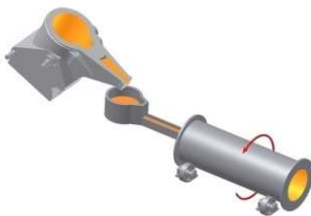
Obr. 29 Schéma horizontálního prostého odstředivého lití [36]
