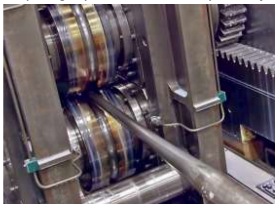
Obr. 12 Poutnické válcování za studena [24]
