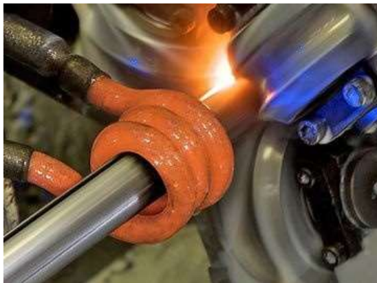
Obr. 36 Indukční ohřev štěrbinové trubky [46]
