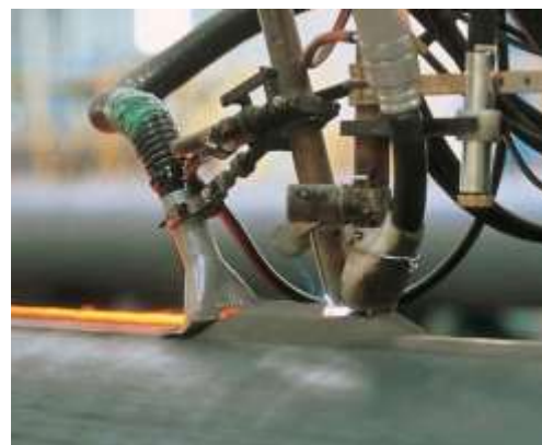
Obr. 38 Automatické tavné svařování pod tavidlem [50]
