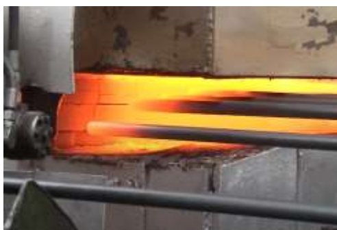
Obr. 20 Ohřev konce trubky pro hrotování za tepla [32]
