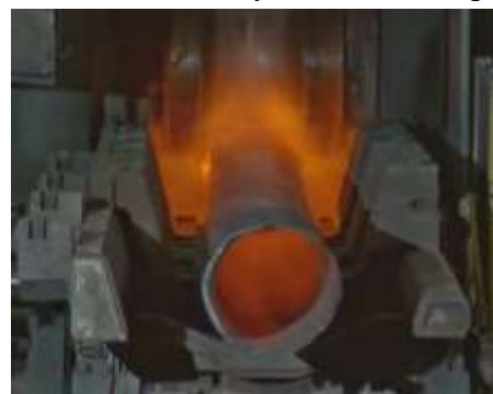
Obr. 11 Neobrobený konec trubky po poutnickém válcování za tepla [23]
