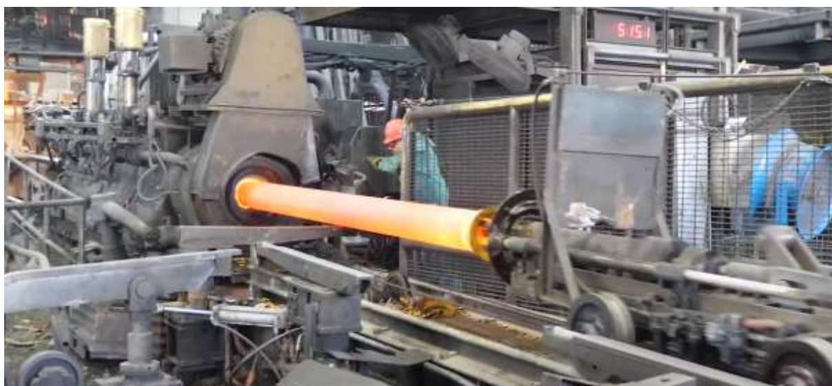
Obr. 30 Vytahování trubky z rotační kokily [38]
