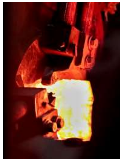
Obr. 27 Sevřený konec trubky [34]
