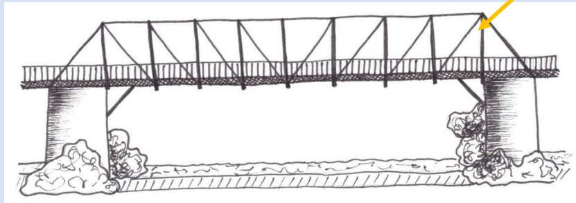
Obrázek 28 – Trámový příhradový most (Zdroj: vlastní)
