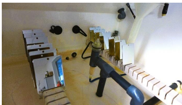
Obrázek 3.13: Testovací komora Ascott S120 a umístění vzorků v komoře (Ascott Analytical Equipment 2023)
