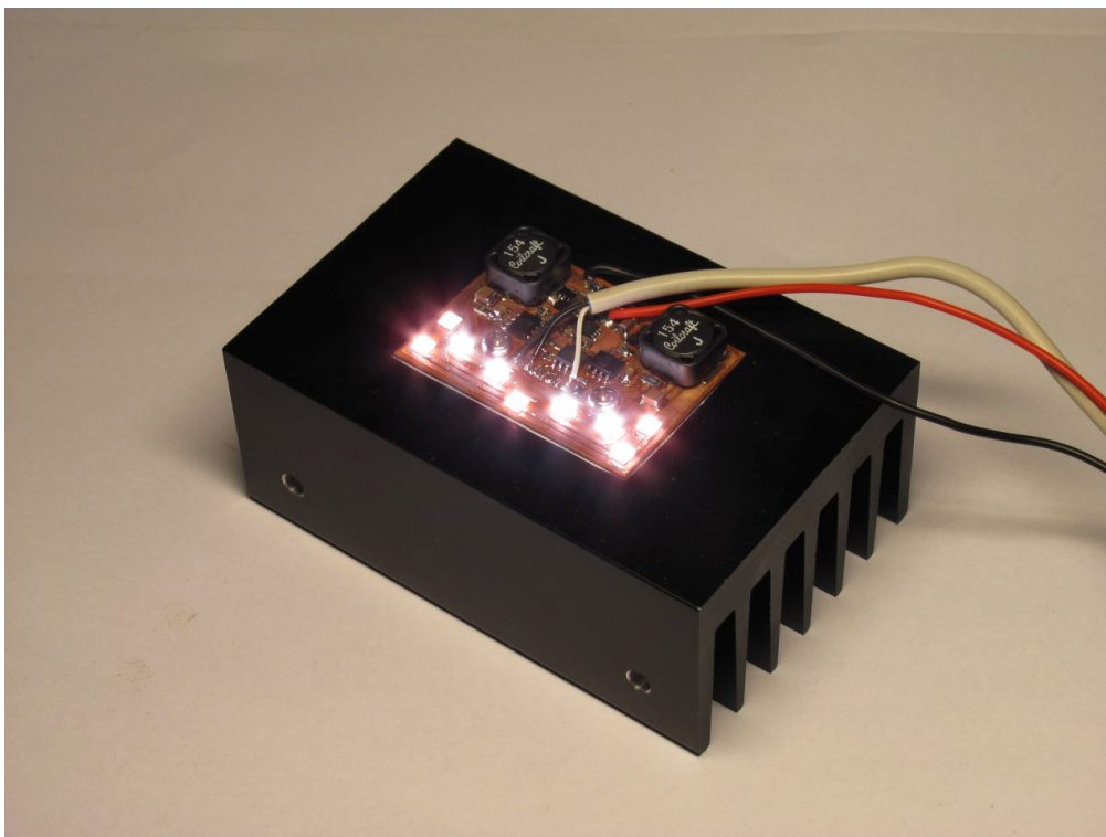
Foto 3: Nastaven přechod mezi teplým a neutrálním odstínem bílé
