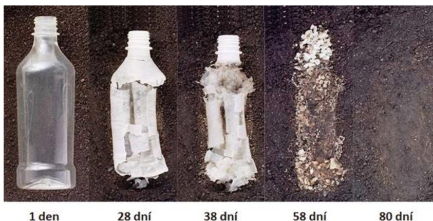
Obr. 2.9 Degradace PLA speciální způsobem kompostování za zvýšené teploty a vlhkosti [27]
