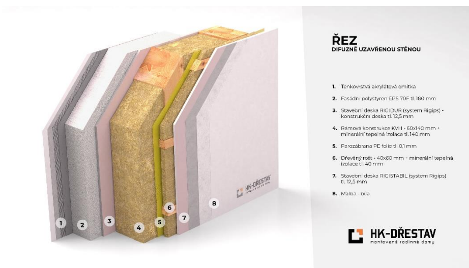
Obrázek 13 - Difúzně uzavřená skladba obvodové stěny s použitou předstěnou (HK-Dřestav ©2024)
