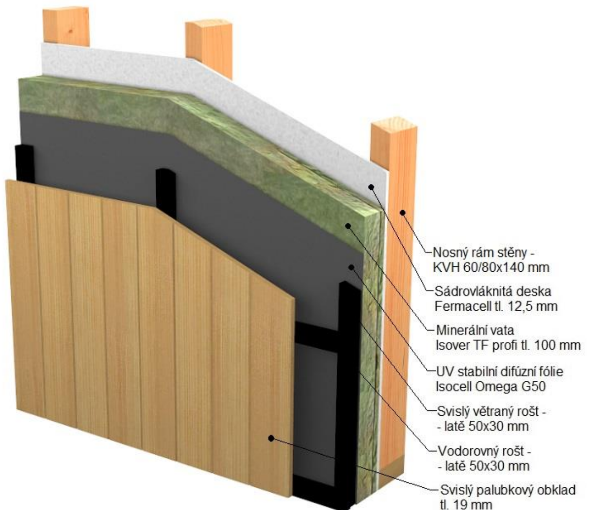
Obrázek 30 - Skladba W4 – štítová stěna RD (autor práce, 2024)
