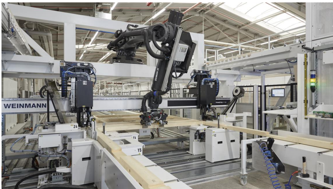
Obrázek 7 - Robotické rameno FEEDBOT F-500 sestavující rám panelu v lince Weinmann (HOMAG ©2021)
