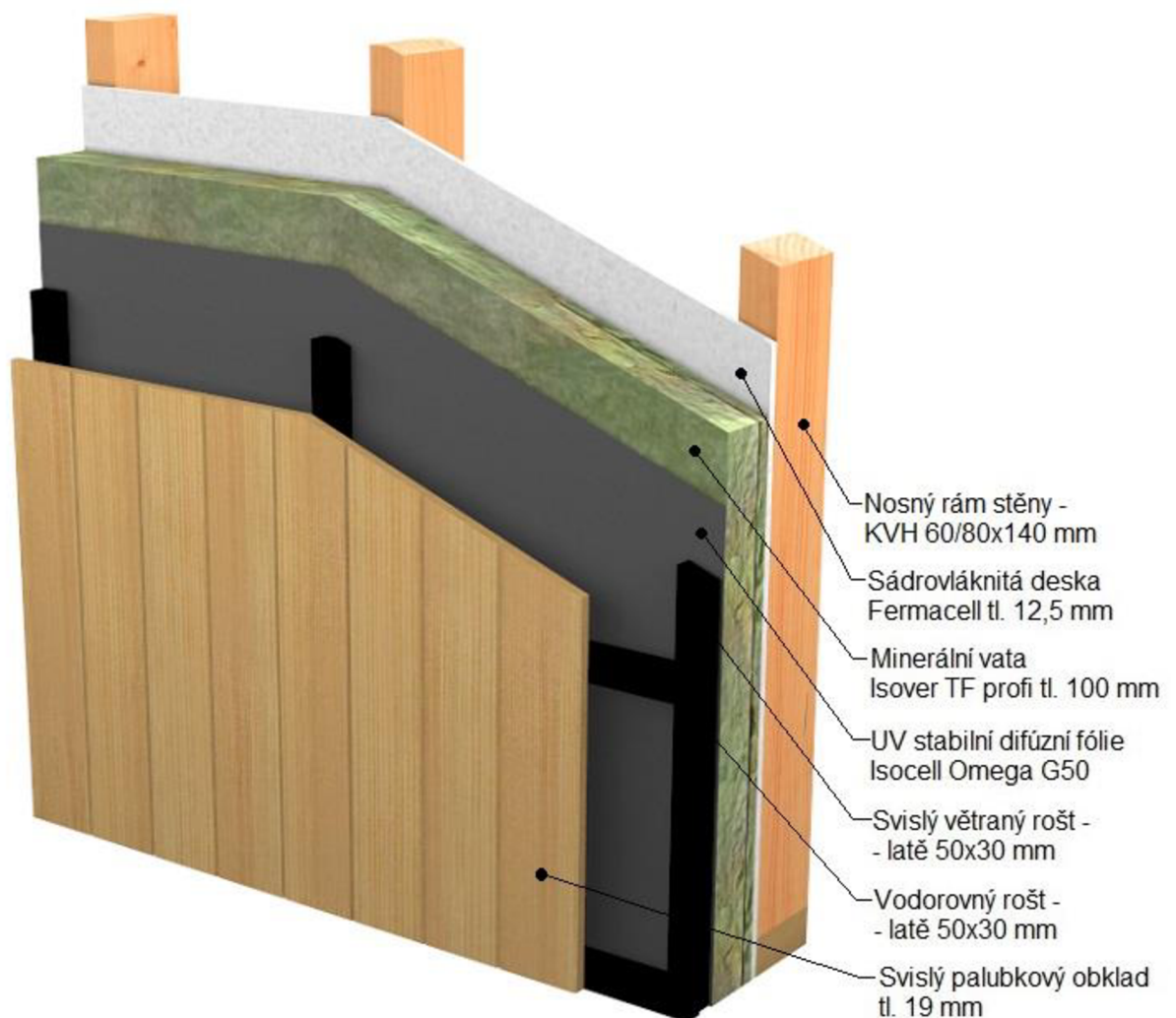
Obrázek 30 - Skladba W4 – štítová stěna RD (autor práce, 2024)
