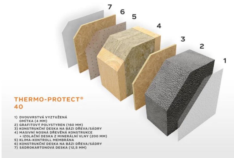
Obrázek 12 - Difúzně uzavřená skladba obvodové stěny bez použití předstěny (Haas Fertighaus ©2017)
