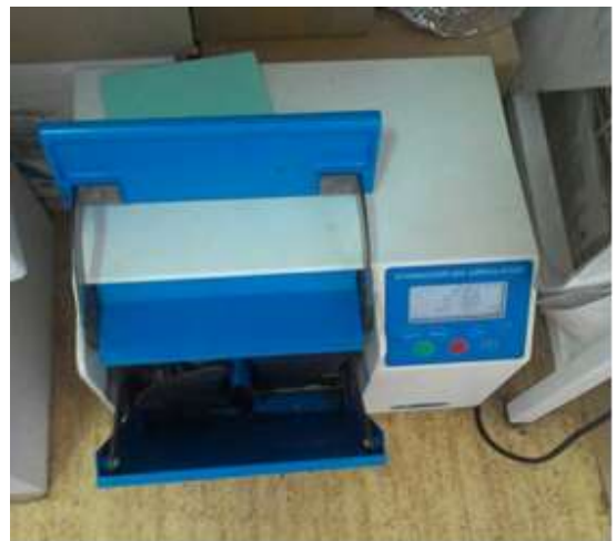
Obrázek č. 1. a 2. Příprava vzorků a homogenizace ve Stomacheru
