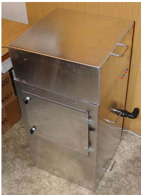
Obrázek 12: Temná komora používaná pro diagnostiku fotovoltaických článků. [1]
