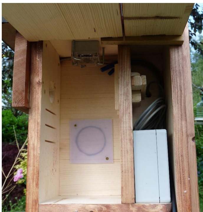
Obr. 10. V pravé oddělené části budky je umístěn počítač, v levé části u stropu je připevněna kamera, mikrofon a čidlo pro snímání vnitřní teploty. (Vlastimil Osoba)
