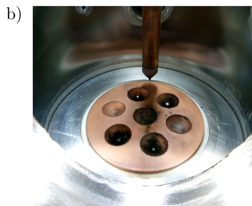
Obrázek 12: Vzorky korozivzdorné oceli (a) před elektrickým obloukem a (b) po něm
