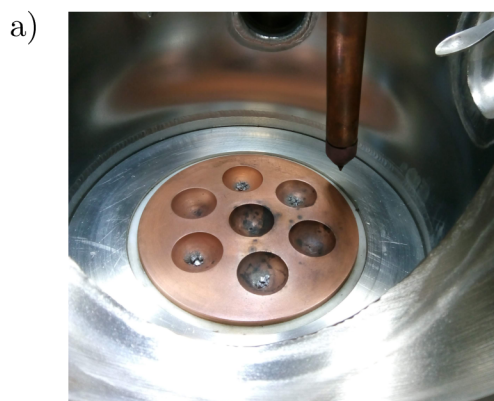
Obrázek 12: Vzorky korozivzdorné oceli (a) před elektrickým obloukem a (b) po něm
