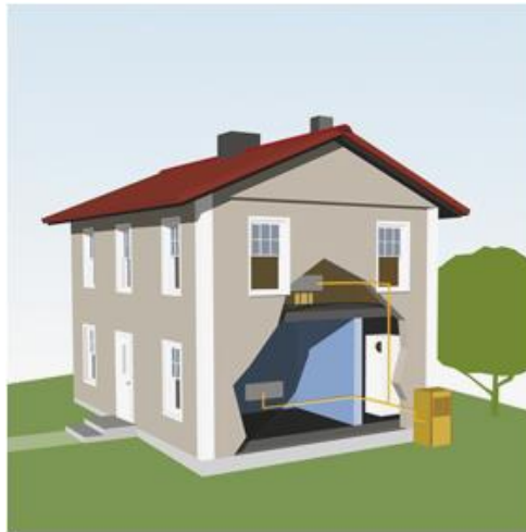
Obrázek 13: Tepelné čerpadlo vzduch/voda [16]
