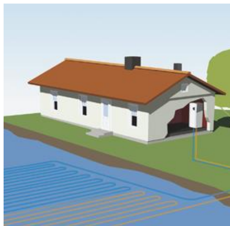
Obrázek 19: Tepelné čerpadlo voda/voda (plocha) [22]
