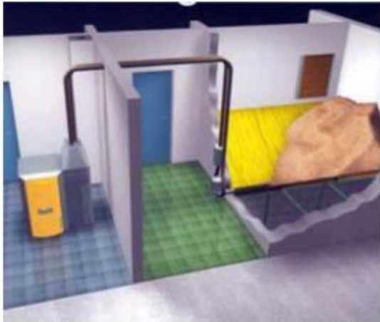
Obrázek 4: Kotel na pelety se skladem pelet [7] Obrázek 3: Kotel na pelety s textilním zásobníkem [7]
