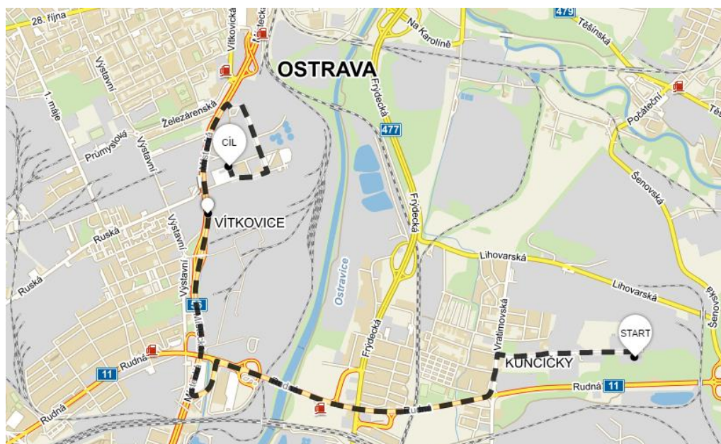
Obr. 53 Trasa č. 1 – Mija – Menmark → Bolt Tower, délka 6,6 km, trasa vedoucí skrz obslužné místní komunikace a částečně po komunikaci I. třídy č. 11 a č. 56, dodávka ocelových prvků
