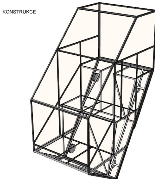
Obr. 20 Ocelová konstrukce kabiny výtahu
