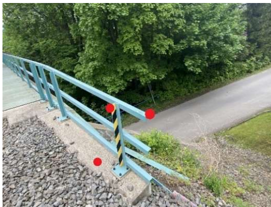
Obr. 15 Ukázka umístění vlíčovacích a kontrolních bodů
