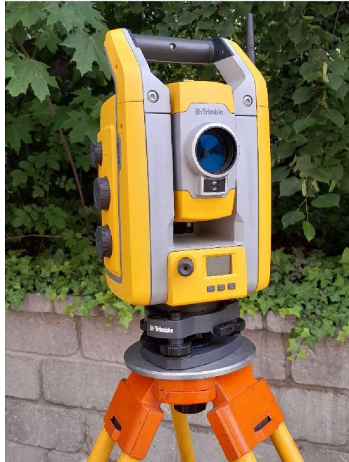
Obr. 16 Totální stanice Trimble S5 1'' DR plus
