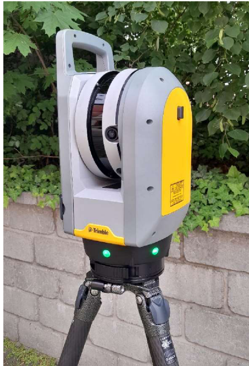
Obr. 29 Laserový skener Trimble X7
