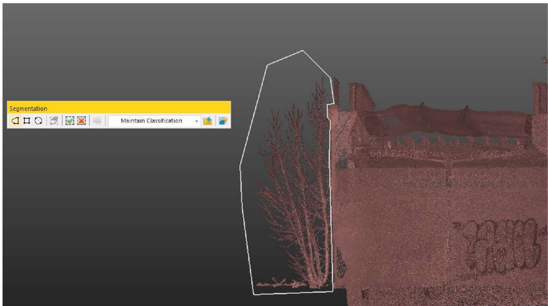
Obr. 26 Ořezávání mračna bodů v softwaru Trimble RealWorks
