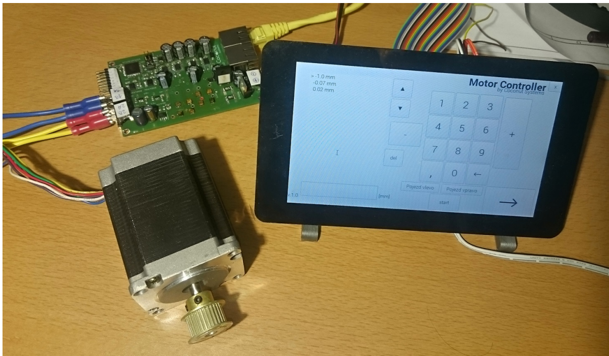
Obr. 8.2: Uživatelská ovládací jednotka pro krokový motor.
