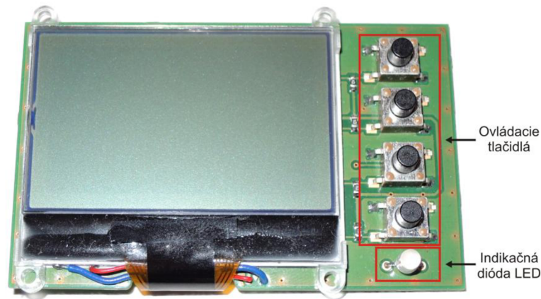
Obr. 17: Riadiaca jednotka - vrchná doska, vrchná strana - osadený plošný spoj
