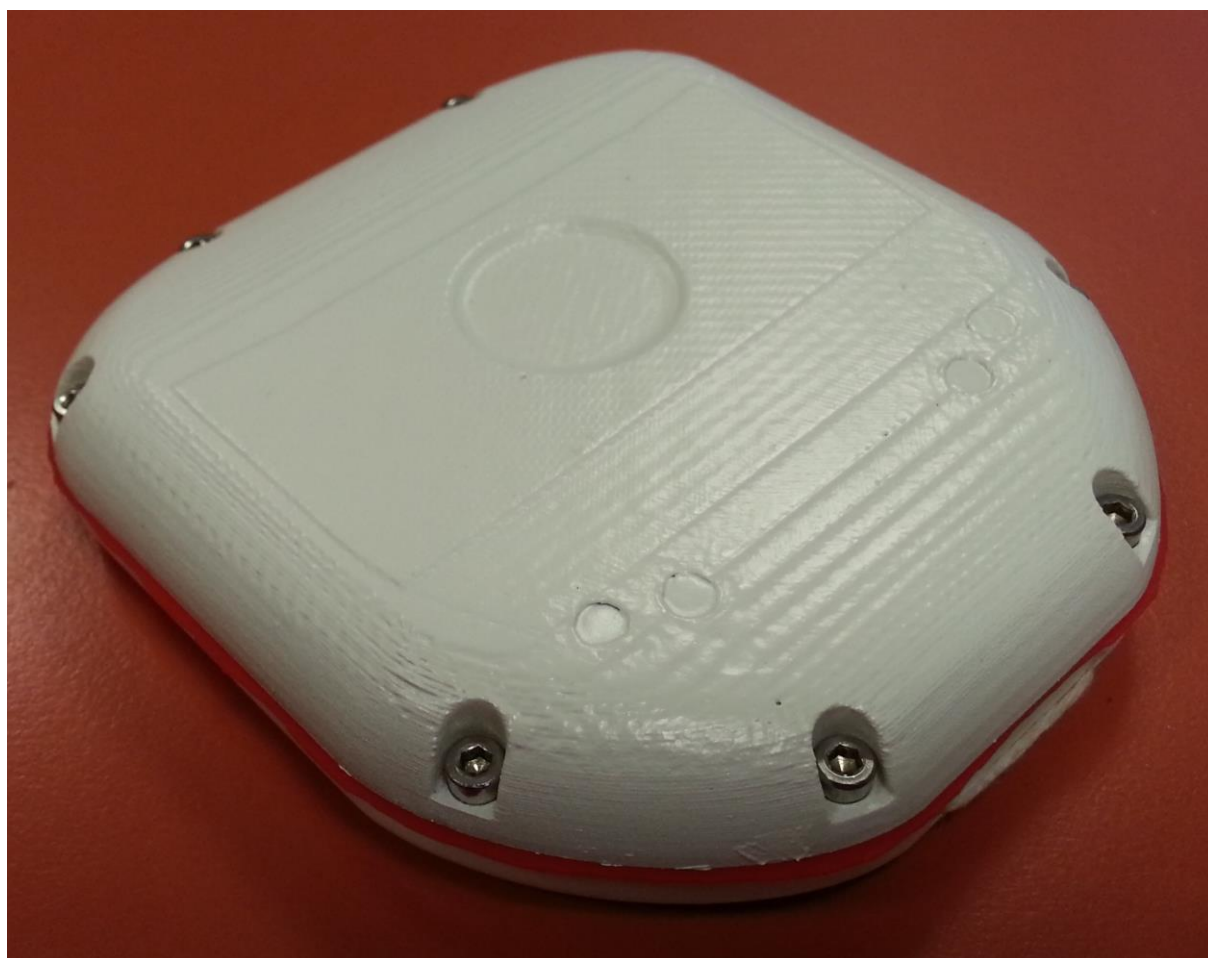
Obr. 33: Inerciální měřicí jednotka testovaná na plavci
