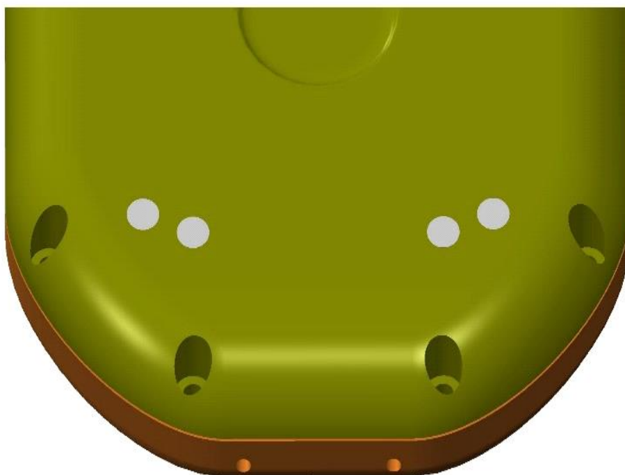
Obr. 18: Rozložení nabíjecích konektorů ve vrchní stěně
