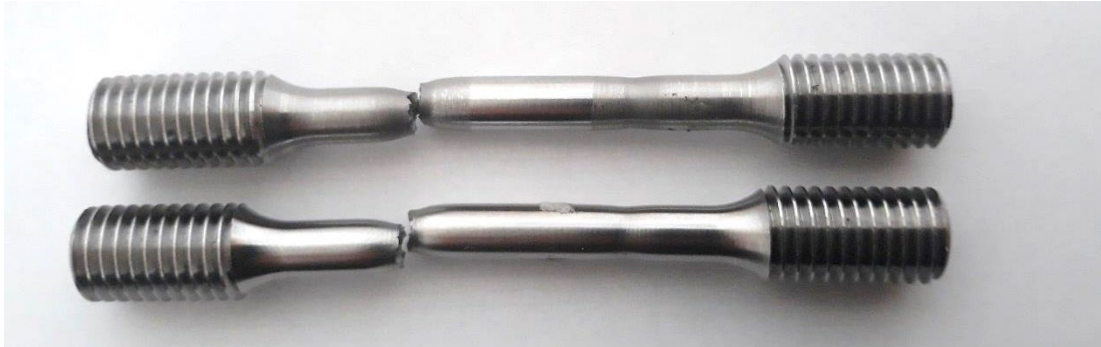
Obrázek 49: Vzorek difúzního svaru materiálu HΦ [33]
