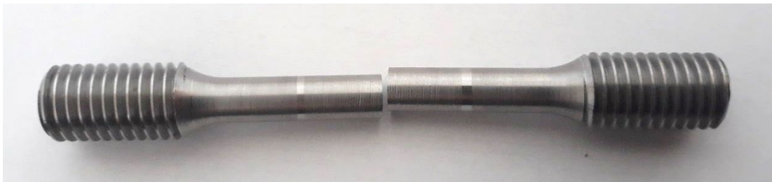
Obrázek 50: Vzorek difúzního svaru materiálu T4 [33]
