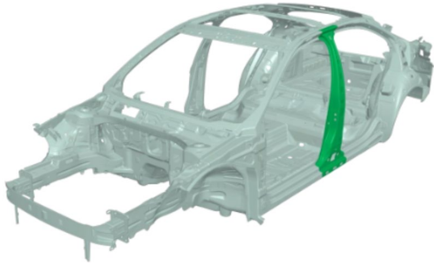
Obrázek 15: Ukázka použití TRIP ocelí v automobilovém průmyslu Škoda Auto a.s. [34]
