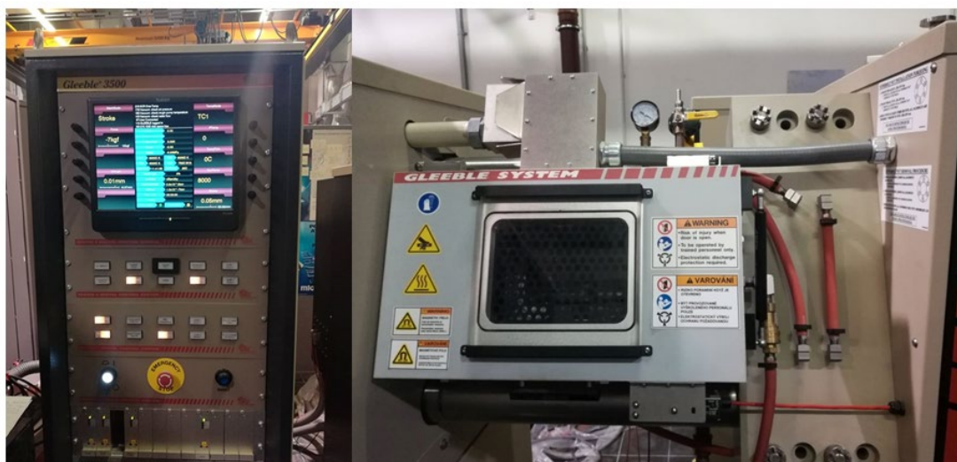
Obrázek 18: Teplotně napěťový simulátor Gleeble 3500 [33]
