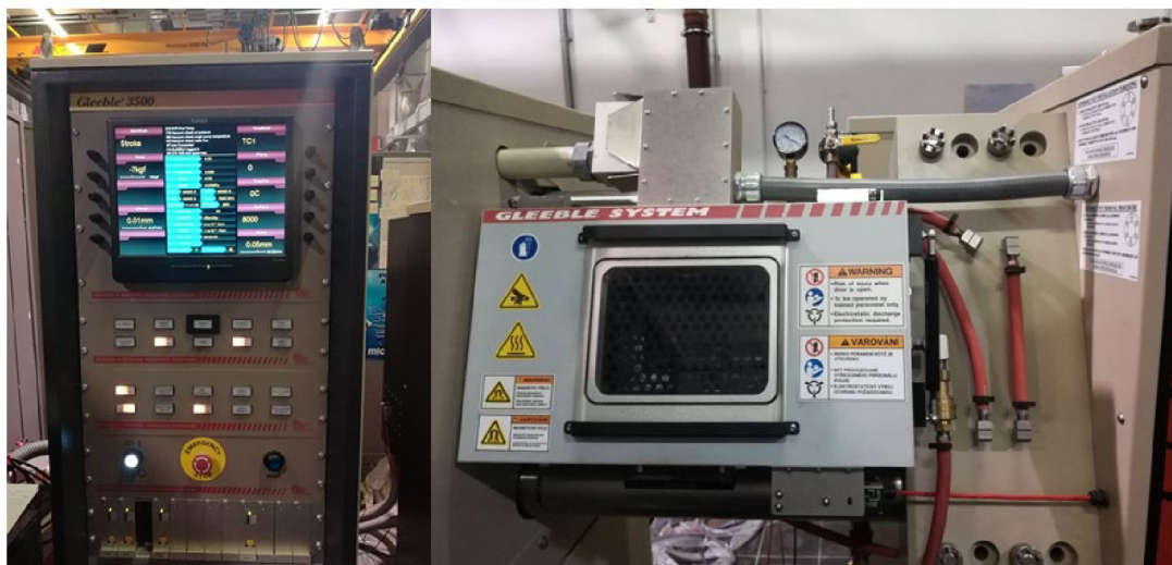
Obrázek 18: Teplotně napěťový simulátor Gleeble 3500 [33]
