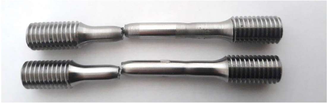
Obrázek 49: Vzorek difúzního svaru materiálu HΦ [33]
