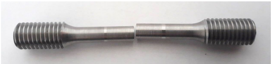
Obrázek 50: Vzorek difúzního svaru materiálu T4 [33]
