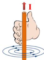
Obrázek 1.1: Ampérovo pravidlo pravé ruky [4]
