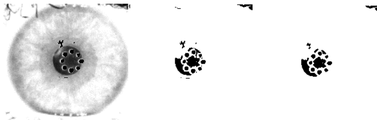
Obr. 9.6: Eliminace diodového pole následované segmentací pupily a operací uzavřením (zleva doprava)
