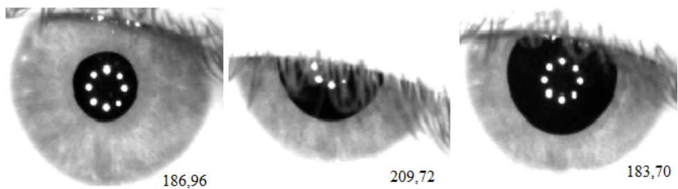
Obr. 8.2: Ukázka správné detekce mrknutí. Zleva vzorový snímek, identifikované mrknutí, dobrý snímek pro detekci. Čísla vpravo dole ukazují průměrnou hodnotu intenzity šedi.
