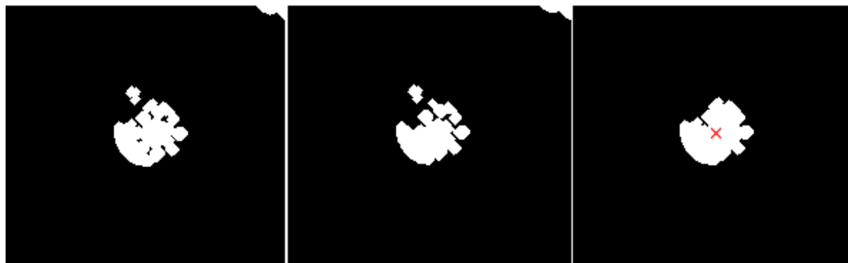
Obr. 9.7: Zleva doprava: operace dilatace, vyplnění děr a výpočet těžiště
