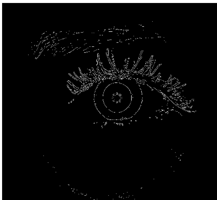
Obr. 9.13: Binární obraz získaný Cannyho hranovým detektorem
