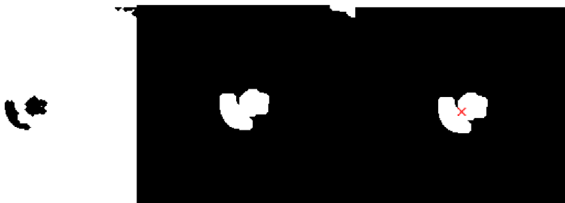
Obr. 9.3: Ukázka zpracování výřezu (zleva doprava): operace uzavření, vyplnění děr po dilataci, výpočet těžiště
