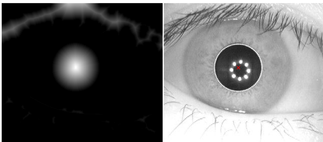
Obr. 4.12: Výpočet Euklidovy vzdálenosti (vlevo) a vyznačení pixelu s nejvyšší hodnotou vzdálenosti jako středu pupily s aproximovanou pupilární hranicí (vpravo)
