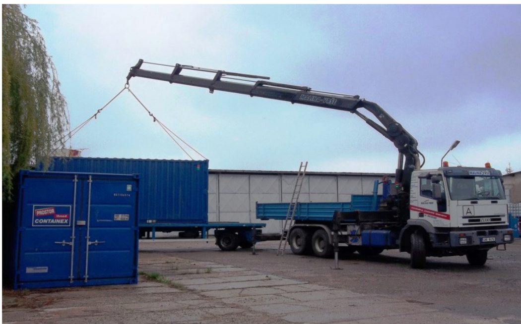
Obrázek 42 - IVECO CURSOR s hydraulickou rukou HIAB 330
