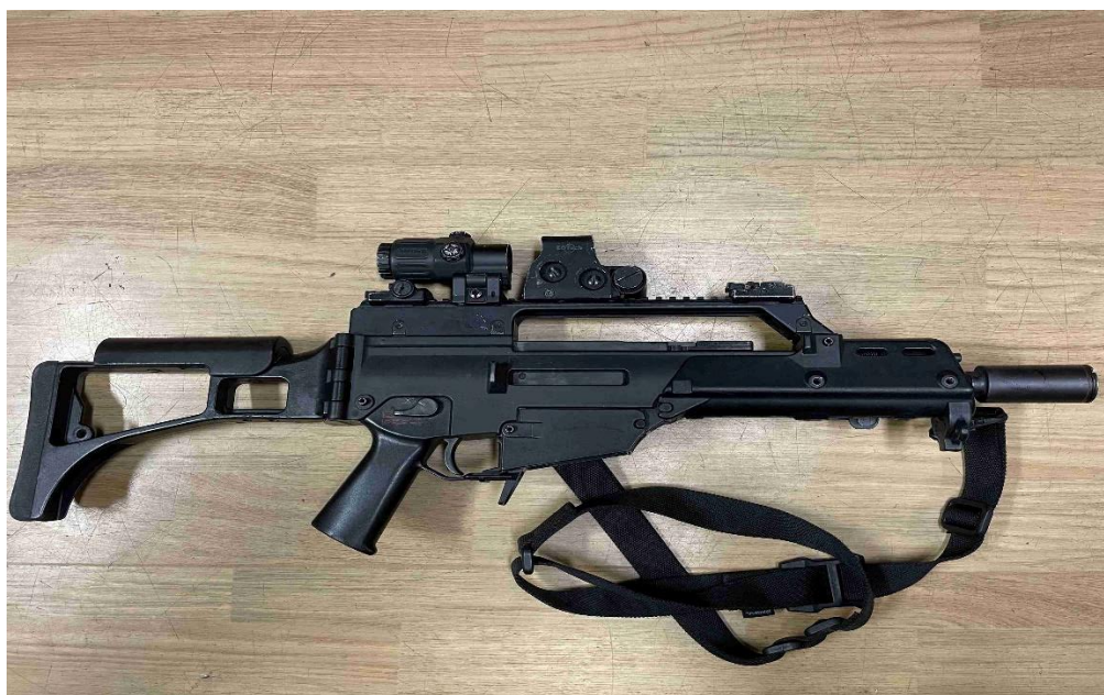
obr. č. 4 – Heckler & Koch G36 C s kolimátorem EOTech, zvětšovací předsádkou (Magnifier 3x), jednobodovým řemením popruhem, tlumičem hluku a svítilnou, zdroj: autor práce
