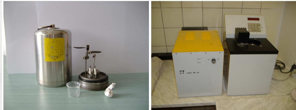
Obr. 4: Suchý adiabatický spalný kalorimetr LAGET MS 10A (foto J. Martinková)
