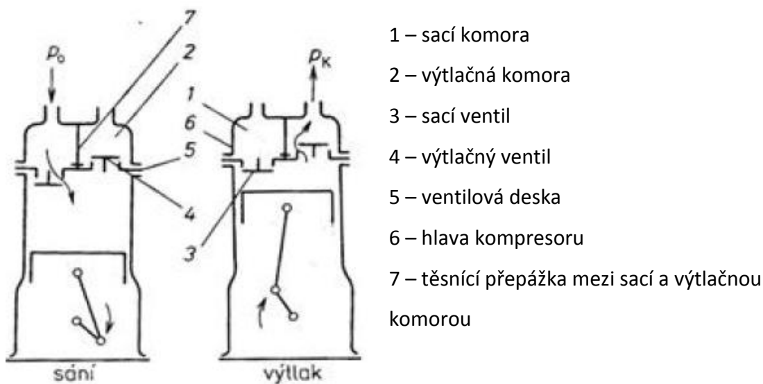
Obr. 4 Protiproudý pístový kompresor s vratným pohybem pístu [5]
