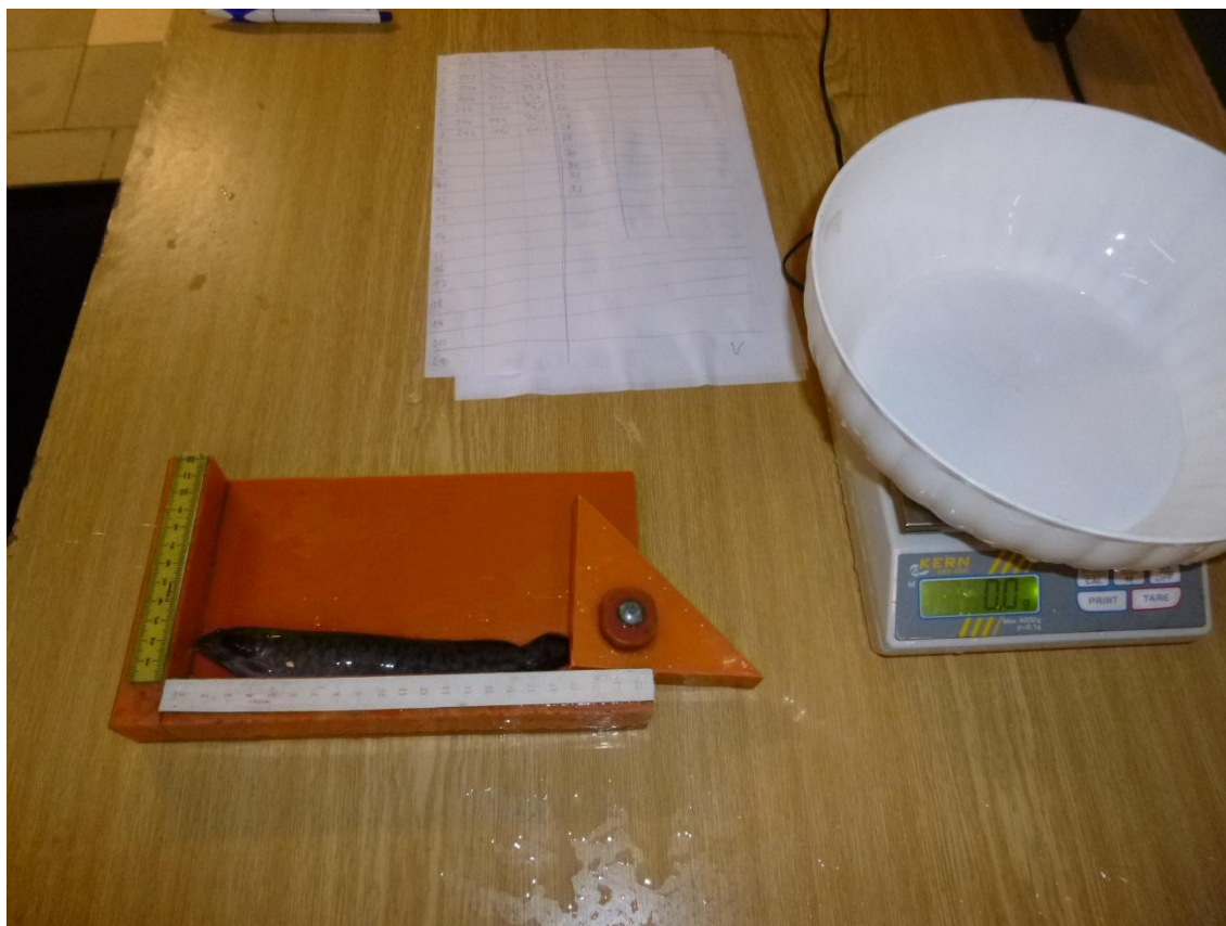
Obr. 5: Zjišťování celkové délky těla mníka jednovousého na konci jednoho období experimentu pomocí biometrické destičky.
