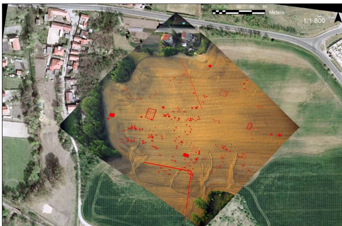
Obrázek 8 - Ukázka rektifikovaného šikmého leteckého snímku nad pokladovou ortofotomapou s manuálně vektorizovanými porostovými příznaky (autor; foto M. Gojda).
