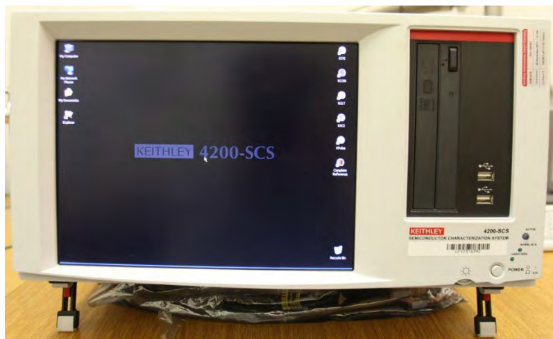
Obr. 5.9. Polovodičový tester 4200-SCS firmy Keithley pro charakterizaci polovodičových součástek
