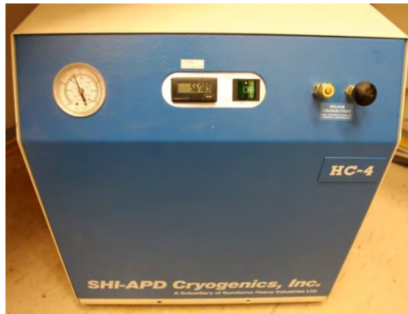
Obr. 5.5. Kompresor obsahující kapalné hélium pro ochlazování kryostatu
