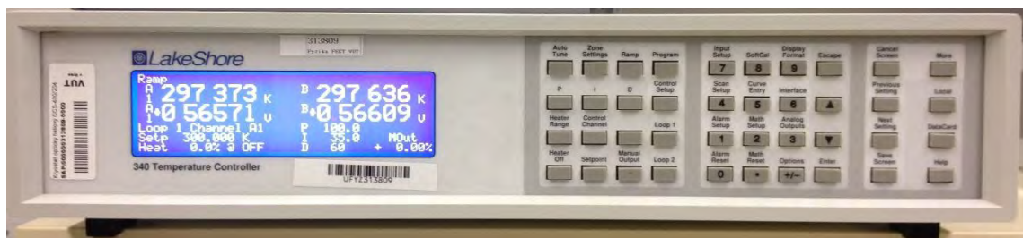
Obr. 5.6. Ovládací panel regulátoru teploty v komoře kryostatu (LakeShore)
